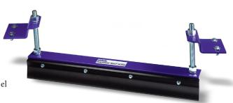
Instalado en un ángulo de 45° a lo ancho de la banda, el Deflector Diagonal RDP1 descarga los materiales fugitivos a un predeterminado lado de la banda para una limpieza más fácil. La hoja se instala en una posición fija, eliminando cualquier problema producidor por saltos o vibraciones que pueden experimentarse con los deflectores de tipo flotantes.
