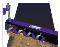
Una hoja única, con forma angulada, rápidamente remueve el material haciéndolo girar en forma de espiral hasta sacarlo de la banda para lograr un trabajo de limpieza muy bueno.
